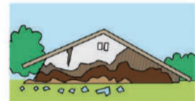
住宅の全体もしくは一部の階がすべて倒壊している。
