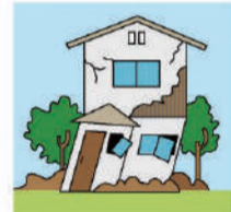
外壁や柱の傾斜が1/20以上である。
