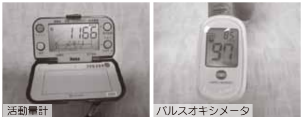
活動量計 ▲消費カロリーや歩数、運動強度などを測定するもので、健康管理に役立ちます。
